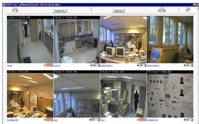
Visualisation d'un groupe de 8 caméras organisées en 4 colonnes. 3 caméras enregistrent. L'opérateur possède les droits d'enregistrement sur toutes les caméras.
