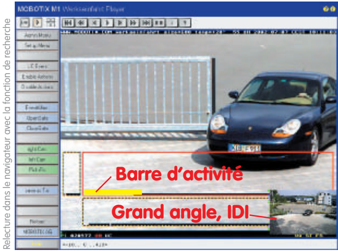
IDI : Visualisation de l'image du second capteur avec objectif grand angle
